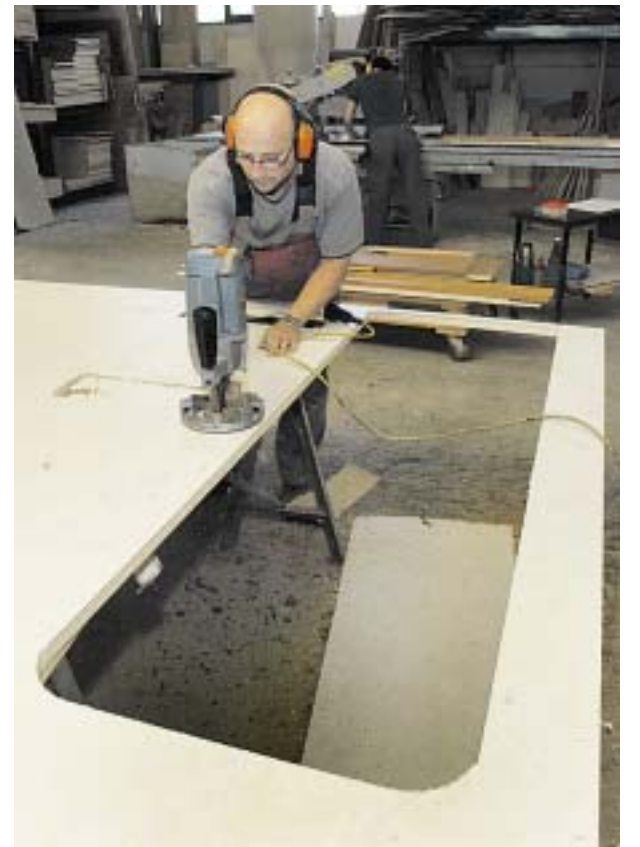
Michael Sichau fräst Türen, Fenster und Lüftungsklappen.
